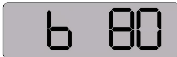
Bild 3-6 Batteriekapazität liegt bei 80 %
