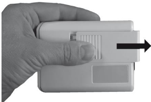
Fig. 3-1 Apertura del vano batterie
