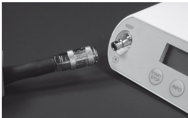
Fig. 2-3 Collegamento del bracciale dei dispositivi PHYSIO-PORT
