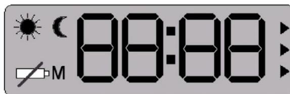
Fig. 3-5 Immagine di prova sul display LCD
