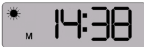
Fig. 3-7 Esempio: aspetto del display dopo il superamento del test autodiagnostico ( M = dati PA in memoria, ☀ fase di misurazione: diurna)
