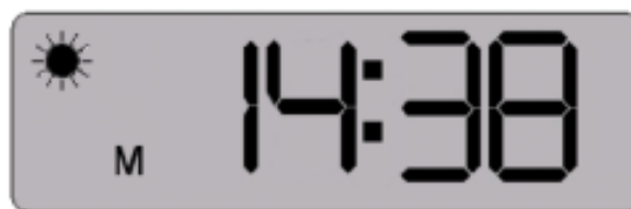
Obr. 3-7 Příklad: Zobrazení po úspěšném autotestu (M = data TK v paměti, ☀ fáze měření: den)
