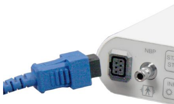
Abbildung 7: Anschluss des SpO2-Sensors
