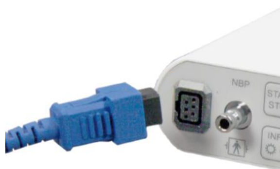
Abbildung 11: Anschluss des SpO 2 -Sensors
