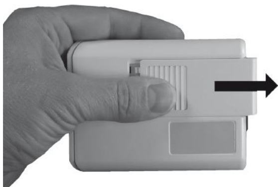
Abbildung 6: Öffnen des Batteriefachs
