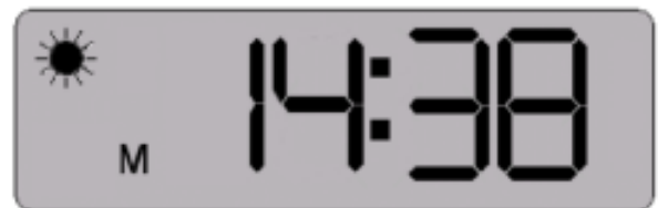
Bild 3-7 Beispiel: Anzeige nach bestandenem Selbsttest (M = Messdaten im Speicher, ☀ Messphase Tag)
