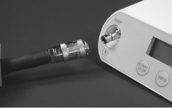
Şekil 2-3 ABPM cihazlarının Manşet bağlantısı
