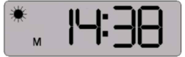
Şekil 3 -7 Örnek: Başarılı kendi kendine testten sonra görüntü ( M = hafızadaki kan basıncı verileri, ölçüm aşaması: gün )
