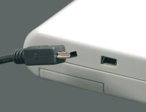
Şekil 2-4 Mini USB bağlantısının bağlanması kablo
