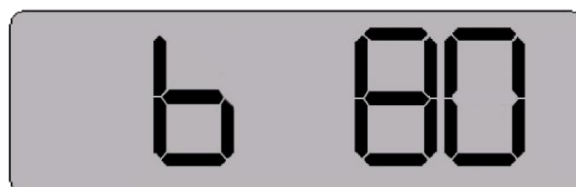
Fig. 3-6 Capacità della batteria pari all'80%
