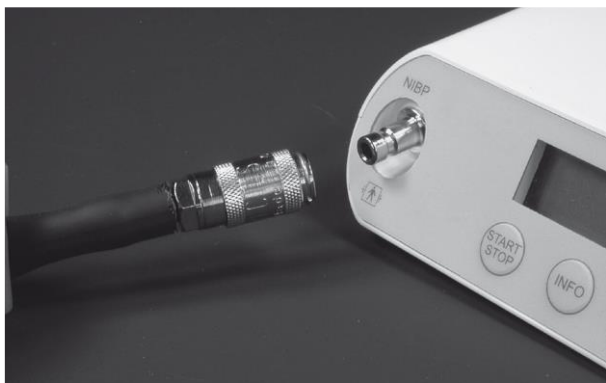
Fig. 2-3 Collegamento del bracciale dei dispositivi PHYSIO-PORT
