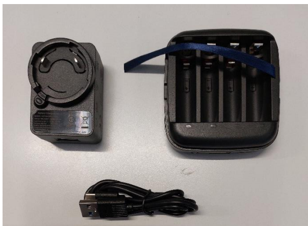
Fig. 3-3 Unità di ricarica e alimentazione con cavo USB
