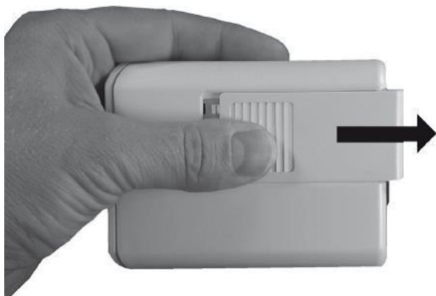
Obr. 3-1 Otvorenie priestoru na batérie
