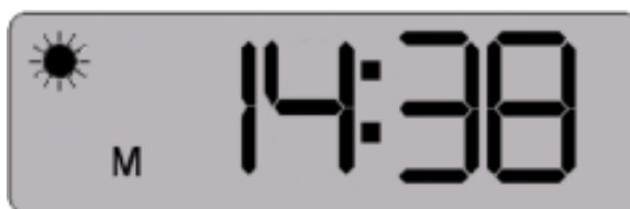
Obr. 3-7 Príklad: Zobrazenie po úspešnom automatickom teste ( M = údaje o tlaku v pamäti, ☀ fáza merania: deň)
