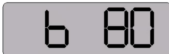
Bild 3-6 Batteriekapazität liegt bei 80 %
